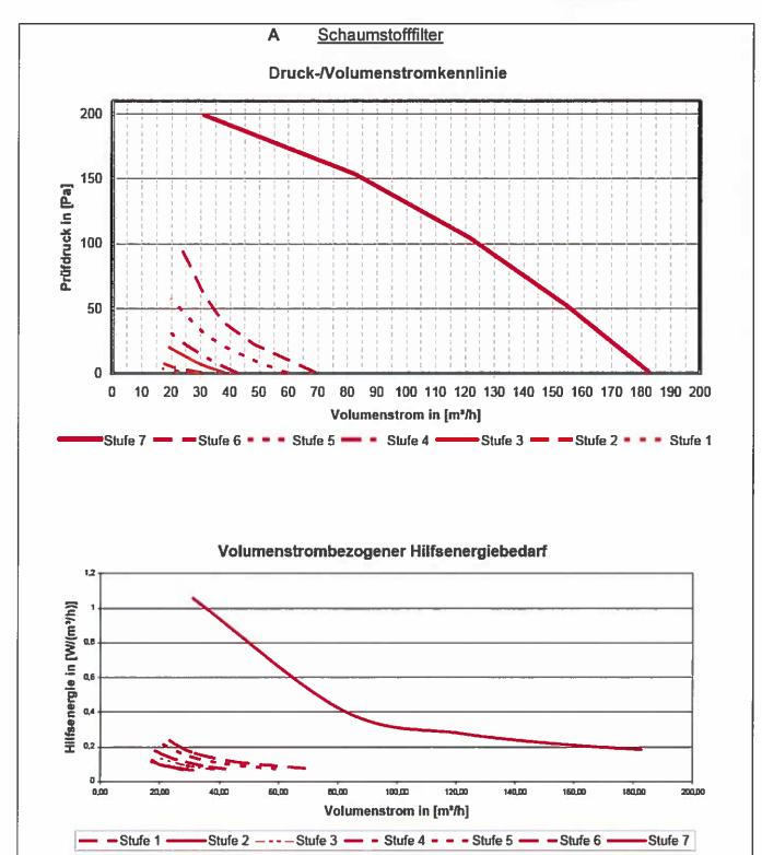
Für den Anlagenluftwechsel ist der für den Auslegungsfall objektbezogene Volumenstrom gemäß DIN 4701-10:2003-08 zu ermitteln. Dieser Volumenstrom ist zu- und abluftseitig einzustellen.
