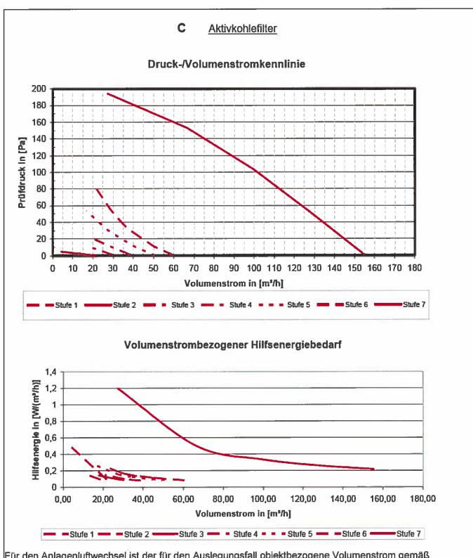
Für den Anlagenluftwechsel ist der für den Auslegungsfall objektbezogene Volumenstrom gemäß DIN 4701-10:2003-08 zu ermitteln. Dieser Volumenstrom ist zu- und abluftseitig einzustellen.
